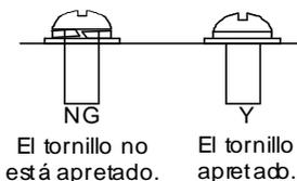
Figura 4-34 Instalación de los tornillos
