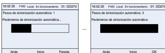
Figura 5-25 Sintonización automática de parámetros
