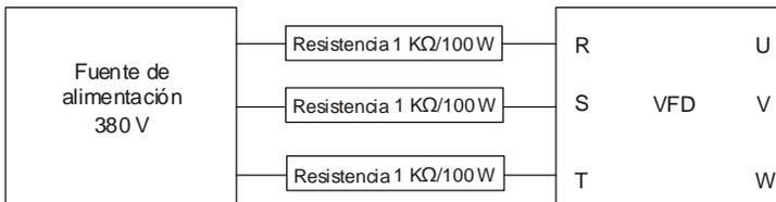
Figura 8-4 Ejemplo de circuito de conducción-carga de 380 V
