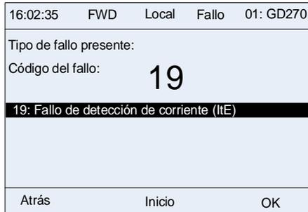
Figura 5-13 Estado de visualización de fallos de la alarma
