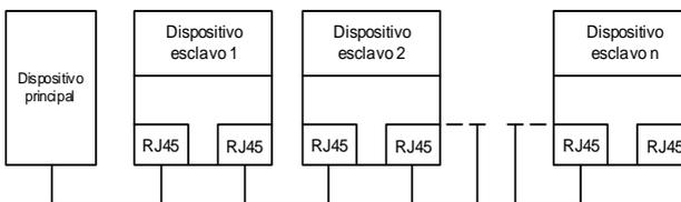
Figura A-7 Topología de red lineal conexión eléctrica
